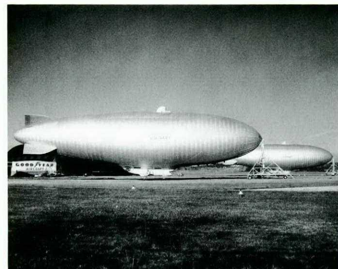
2. Les blimps de "détection avancée" fabriqués par Goodyear pour la Marine américaine et en service jusqu'en 1962 étaient les plus gros et les derniers dirigeables commandés par ce Service. Une antenne radar rotative de 40 pieds était installée dans l'enveloppe de 85 pieds de diamètre. Le "ZPG3W" mesurait 400 pieds de longueur, pesait 47 tonnes et était propulsé par deux moteurs de 1520 hp qui donnaient au dirigeable une vitesse de 90 m/h, une charge utile de 11 tonnes et un rayon d'action de 5000 milles. L'équipage de 24 hommes était confortablement logé dans une nacelle de 83 pieds pendant des patrouilles qui pouvaient durer jusqu'à 80 heures.
