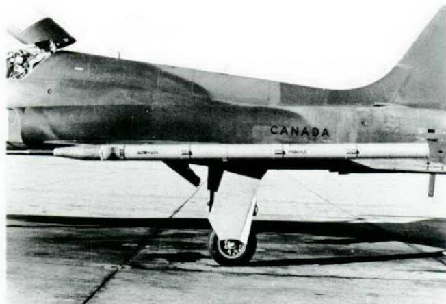
nacelle AIS montée sur l'aile gauche d'un CF5
