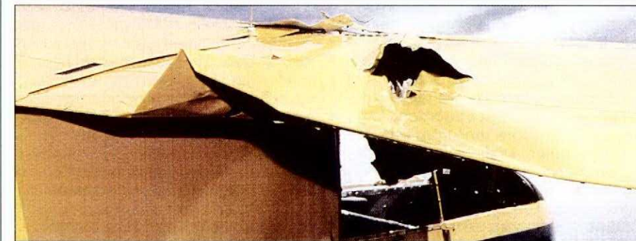
Dommages à l'intérieur de l'aile droite.
