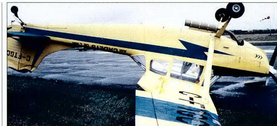
Vue du côté gauche. Dommages à l'aile, hélice et empennage.
