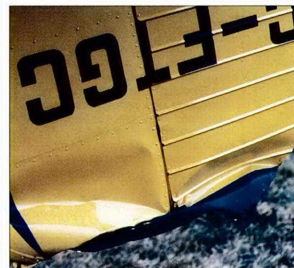
Dommage d'impact - empennage.
