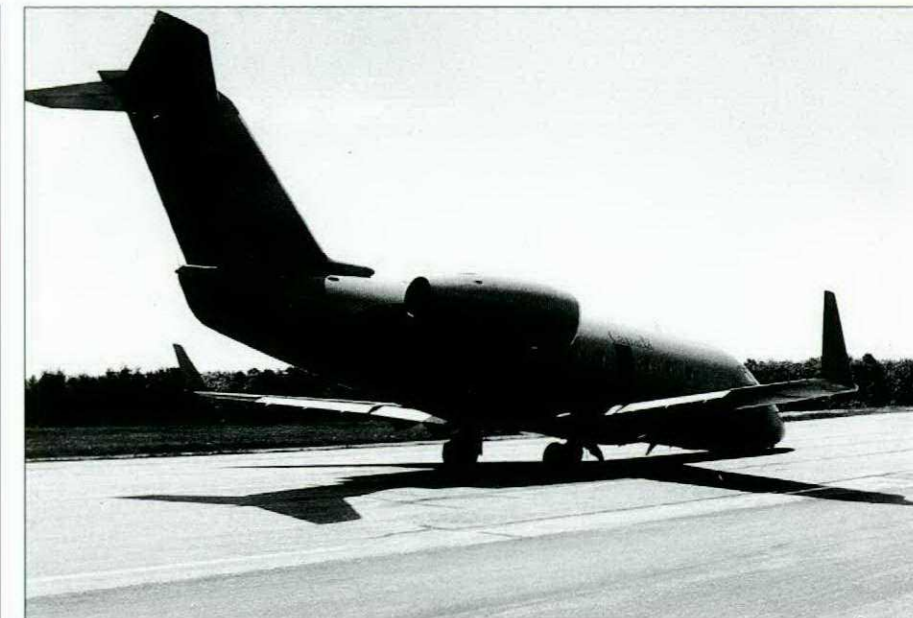
Le CC144604 sur la voie de circulation reposant sur le nez
