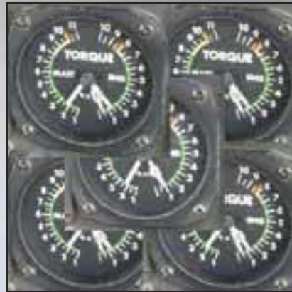
Un collage d'indicateurs de couple du Griffon montrant « l'écart des aiguilles » – pas exactement représentatif des conditions de vol, mais ce donne une bonne idée.
