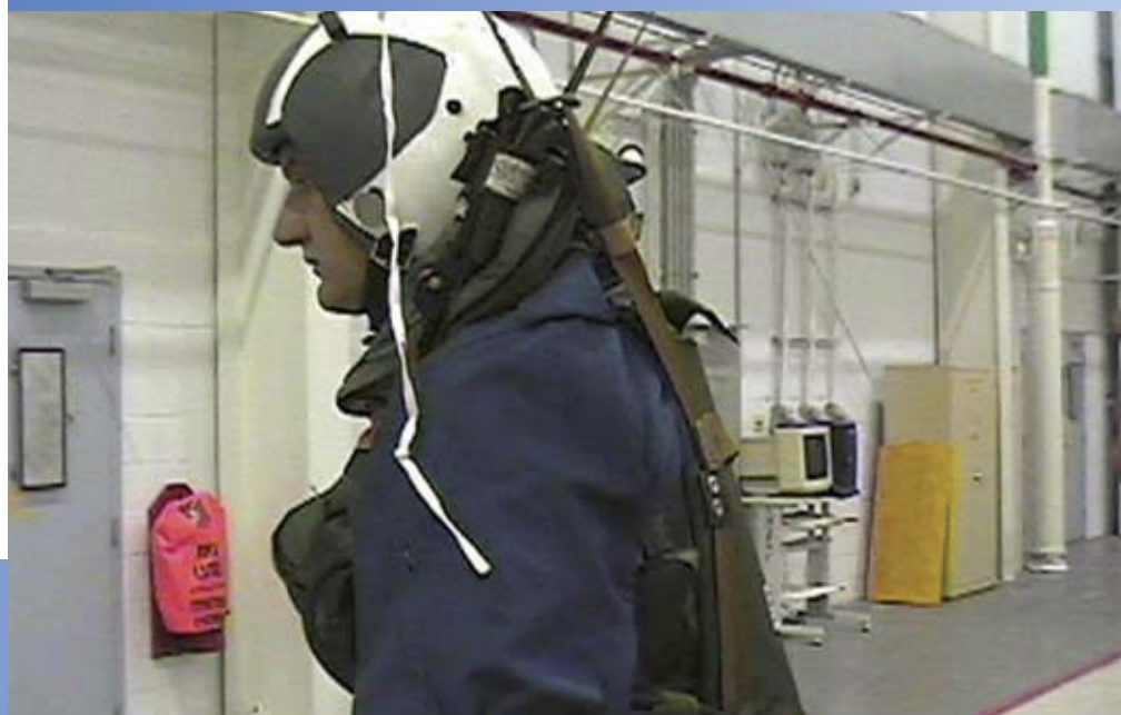
Figure 3. Essai de suspension montrant le trop grand vide triangulaire aux dessus des épaules
