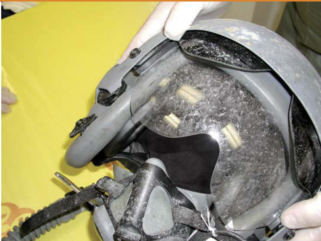
Figure 4. Casque, visière et masque endommagés par le CDM et les éclats de verrière
