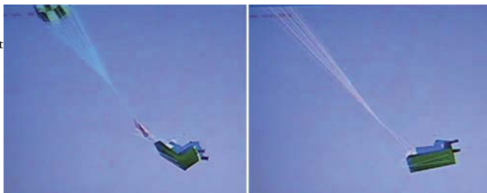
Figure 2. Extraction du parachute principal par le parachute de freinage; approximation du mauvais alignement du siège/du pilote avec l'axe d'ouverture du parachute principal
