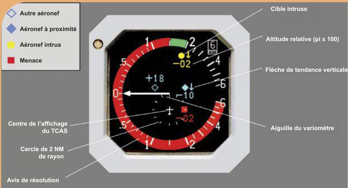
Figure 3 – Affichage du TCAS sur un variomètre (VSI)
