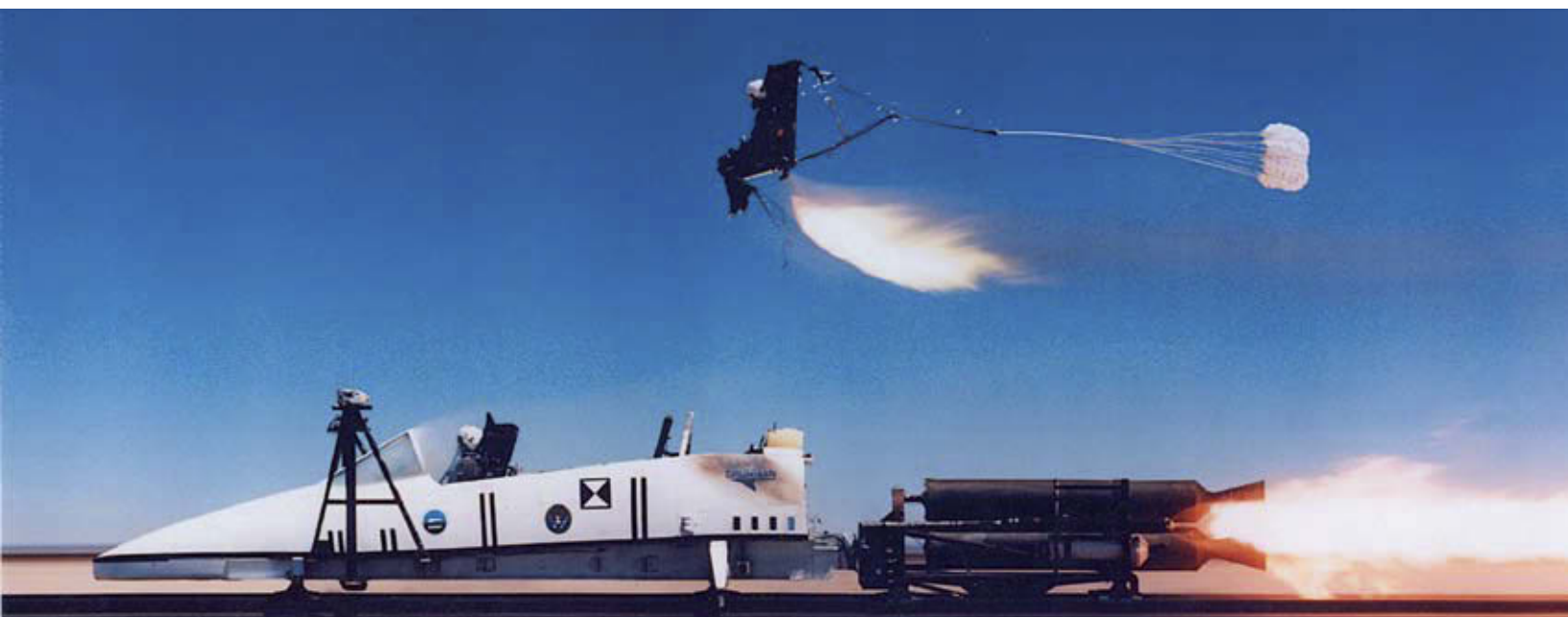
Figure 1a. Test du siège éjectable NACES montrant le parachute de freinage à plusieurs points d'attache
