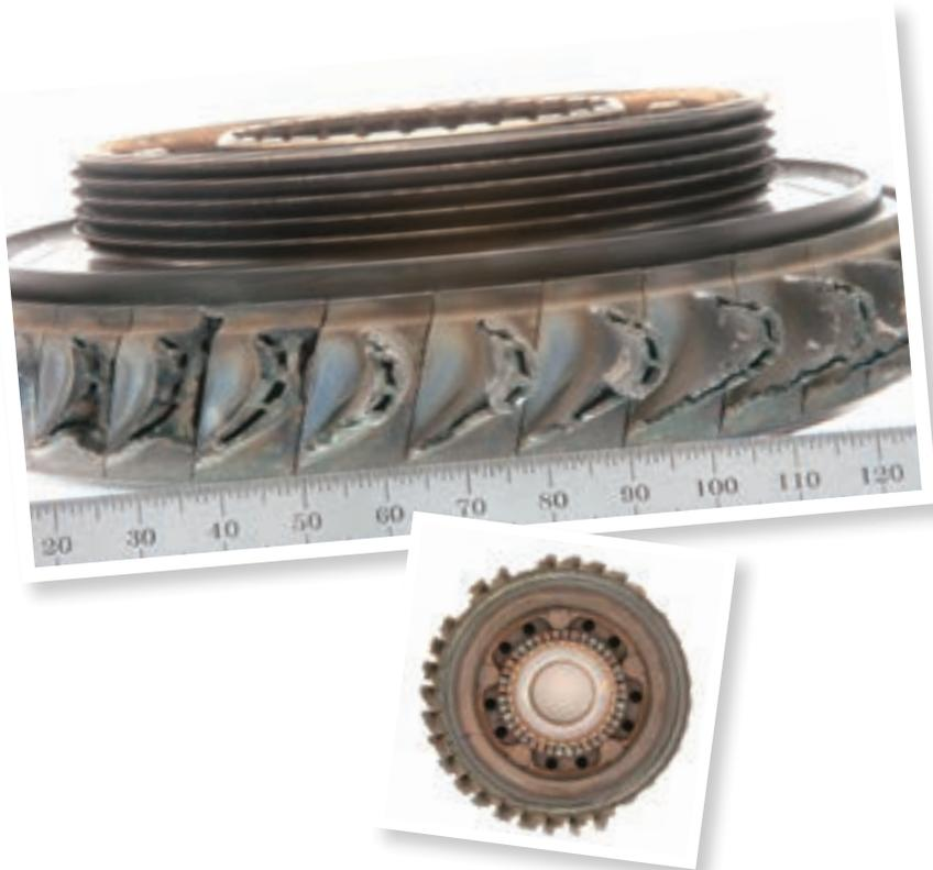
de turbine. Le fabricant d'origine a indiqué qu'une sulfuration semblable avait déjà été constatée sur ce type de moteur, dans un appareil de catégorie navette.
