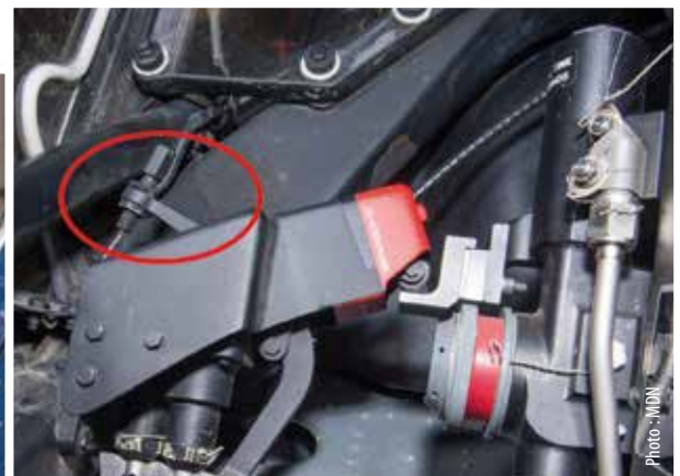
Cette photo montre un dispositif de mise à feu du cordeau détonant miniature fonctionnel à l'avant du poste de pilotage d'un autre appareil.
