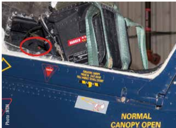
Cette photo montre un dispositif de mise à feu du cordeau détonant miniature fonctionnel à l'avant du poste de pilotage d'un autre appareil.
